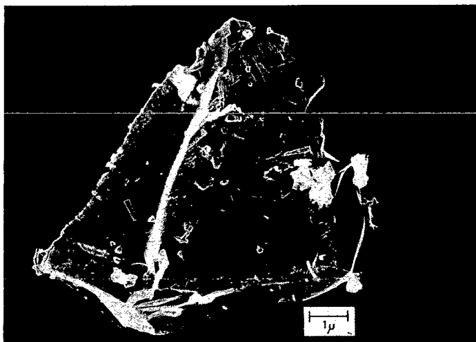
Microfotografía electrónica de las partículas captadas en un punto de vuelco de basculadores.
