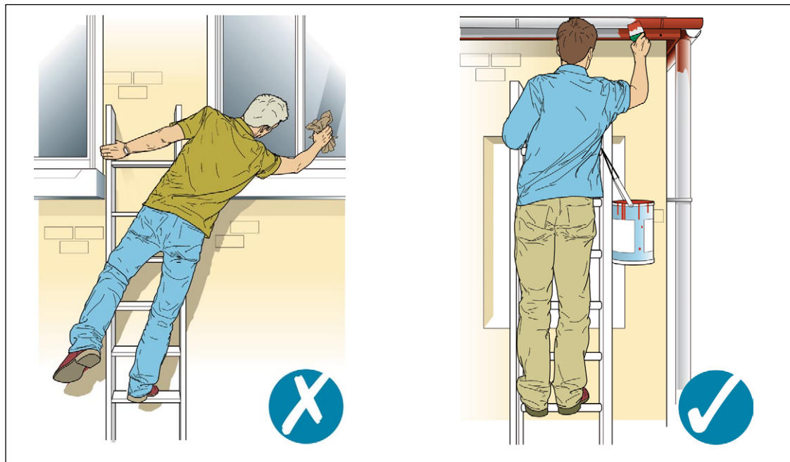
Figura 24. Poziția de lucru pe scară incorectă.
