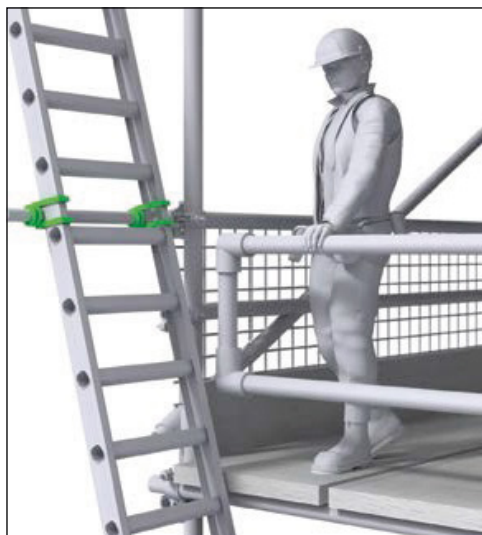
Figura 12. Scară poziționată corect și fixată la marginea platformei de acces.
