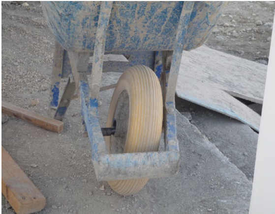
Figura 50. Roabă cu rulment de roată prost întreținută.
